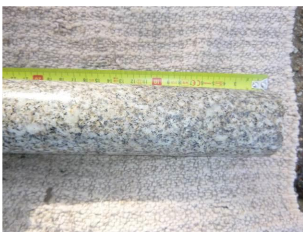
Pohled na vývrt a strukturu žulového kamene.
