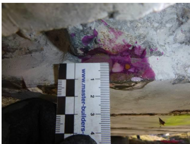
Naměřená karbonatace 10 mm.
