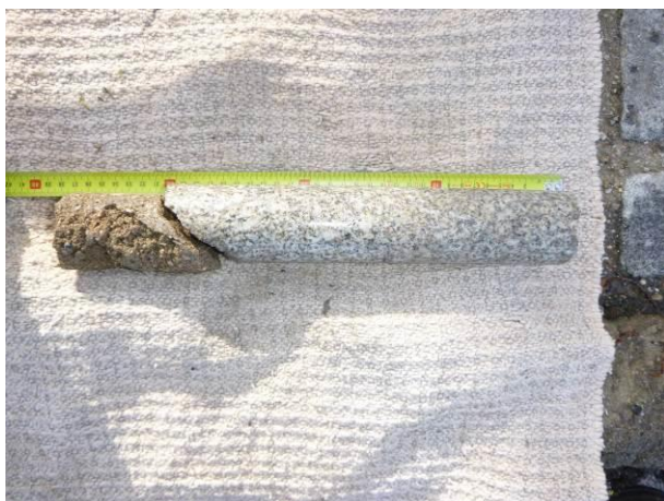
Opěra se skládá z cca 30 cm žulový kámen, následuje 60 cm beton.
