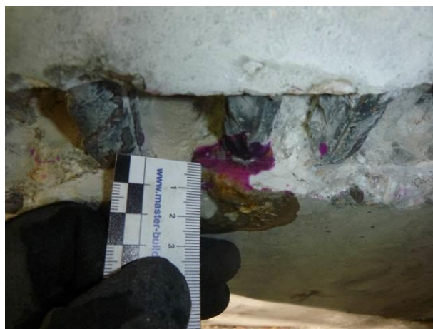
Naměřená karbonatace 10 mm.
