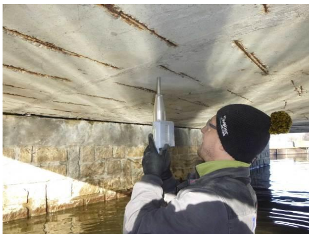
Pohled na nedestruktivní měření pevnosti betonu v tlaku.
