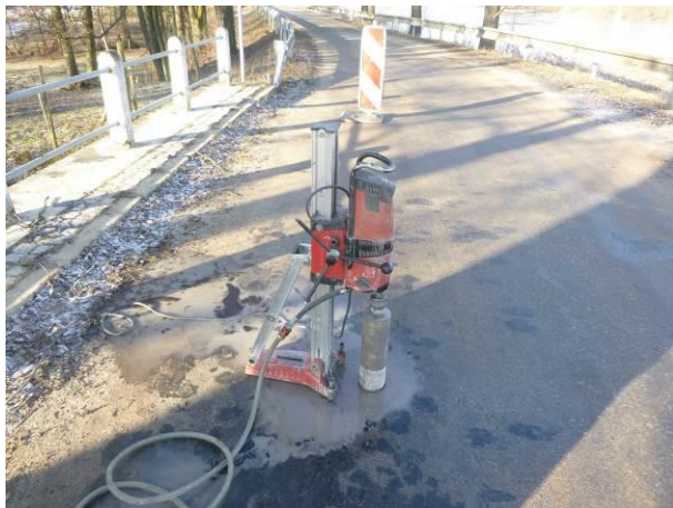
Pohled na jádrové vrtání do krytu vozovky.
