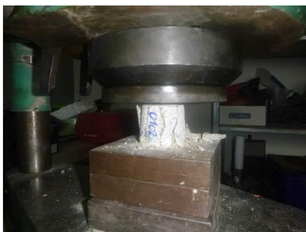
Pohled na porušený vzorek.
